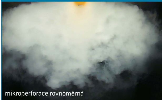
Příklady obrazů proudění vytvořených kouřovou zkouškou ve zkušebně PŘÍHODA s.r.o.
